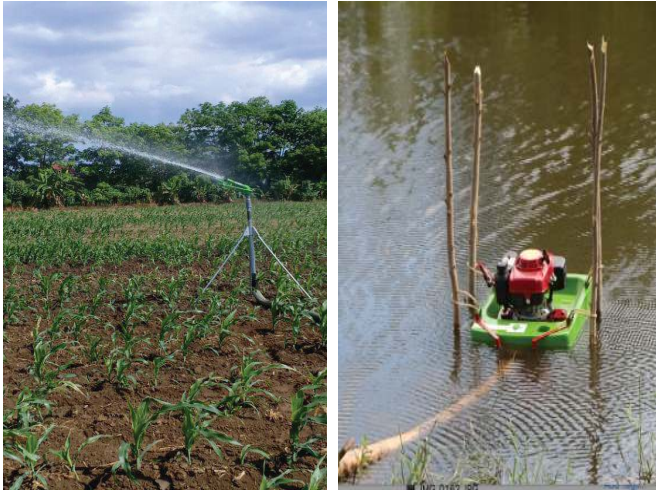
Gambar 5.20 Penyiraman dengan gun sprayer menggunakan air dari pompa apung
