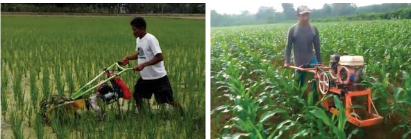
Gambar 5.24 Power weeder untuk penyiangan tanaman padi (kiri) dan kultivator untuk penyiangan tanaman jagung (kanan)
