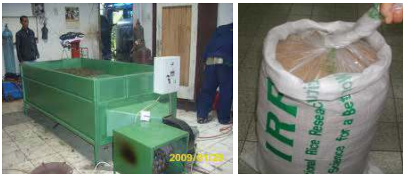
Gambar 5.13 Mesin pengering dan penyimpanan benih dengan kantong
