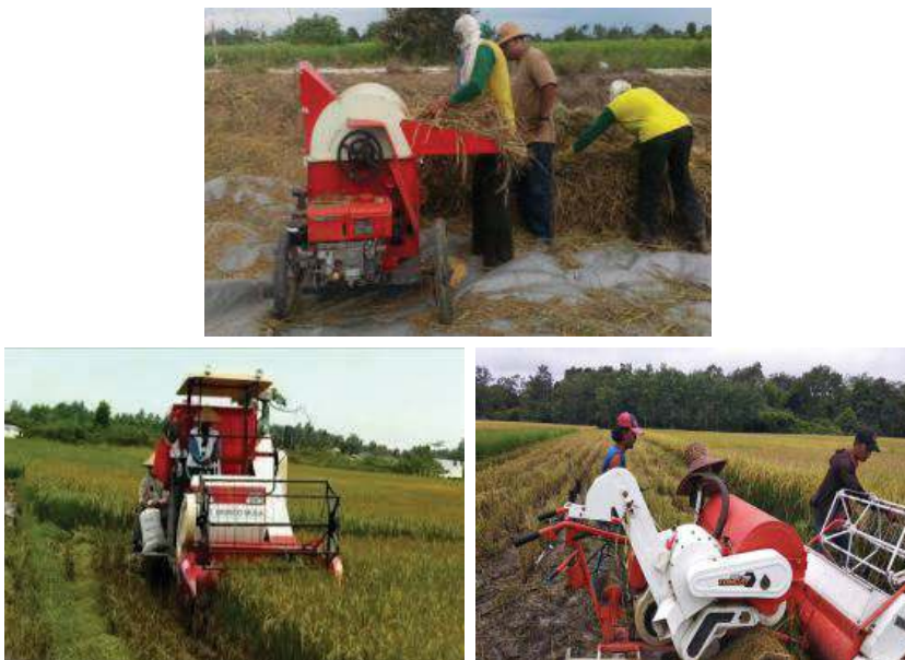
Gambar 5.12 Power thresher (atas) dan mini combine harvester (bawah)
