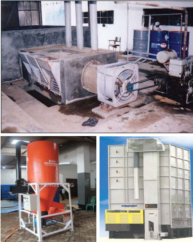
Gambar 5.27 Mesin pengering berbahan bakar sekam tipe boks horizontal (atas), tipe vertikal silo (bawah-kiri), dan tipe vertikal boks kapasitas 10 ton/batch (bawah-kanan)
