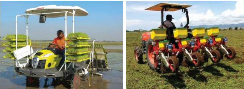
Gambar 5.23 Mesin tanam ( transplanter ) padi (kiri) dan mesin tanam biji ( grain seeder ) jagung (kanan)
