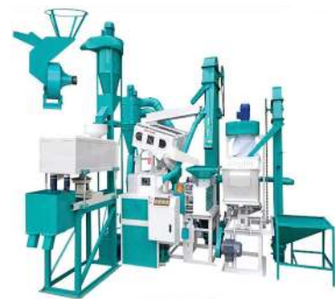
Gambar 5.30 Beberapa pilihan unit penggilingan padi modern dengan kapasitas 1-3 ton per jam
