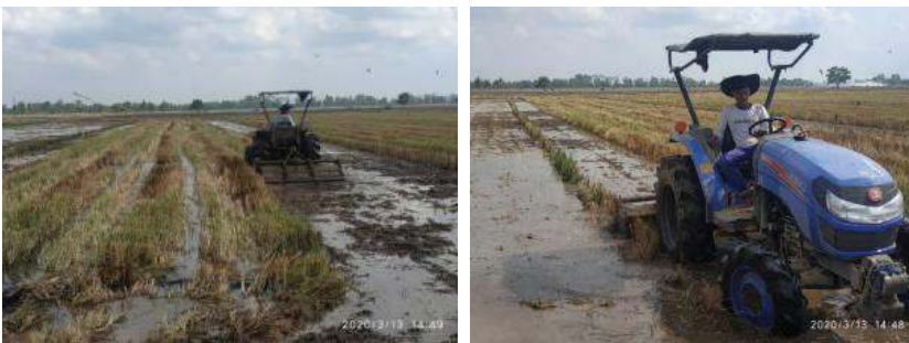
Gambar 5.8 Traktor roda empat cocok untuk rawa lebak dan pasang surut tipe luapan C
