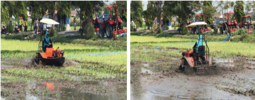
Gambar 5.7 Traktor roda dua model perahu cocok untuk lahan rawa
