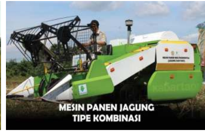
Gambar 5.26 Combine harvester untuk padi (kiri) dan untuk jagung (kanan)
