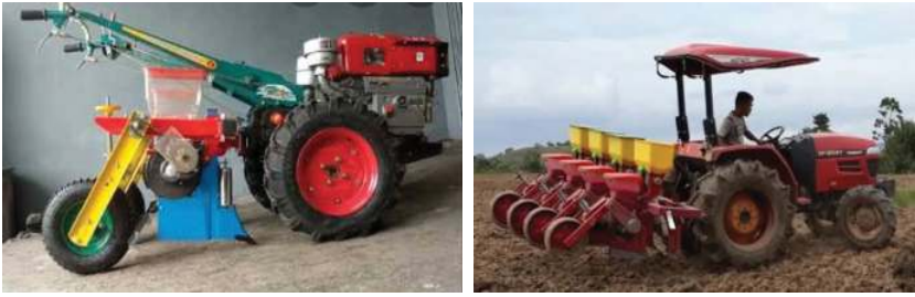
Gambar 5.17 Alat tanam jagung yang ditarik traktor roda dua (kiri) dan traktor roda empat (kanan)
