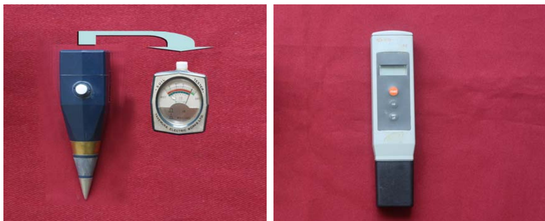
Gambar alat pengukur pH tanah setempat (kiri) dan alat pengukur pH tanah digital (kanan)
