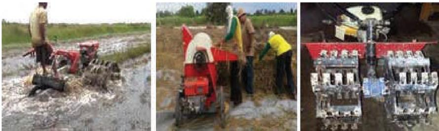
Gambar 18. Traktor kura-kura (kiri), thresher sederhana (tengah) dan power weeder (kanan).
