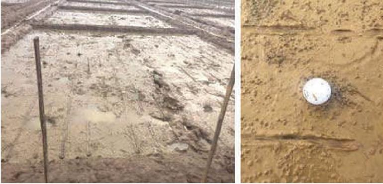
Gambar 11. Uji kekerasan permukaan tanah agar sesuai untuk sistem tanam benih langsung
