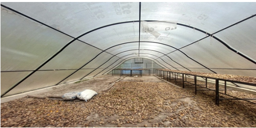
Gambar 24. Penjemuran buah pinang dalam Solar Dryer Dome
