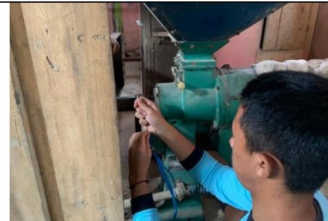
Proses maintenance (menjahit) bagian v-belt pada mesin polisher
