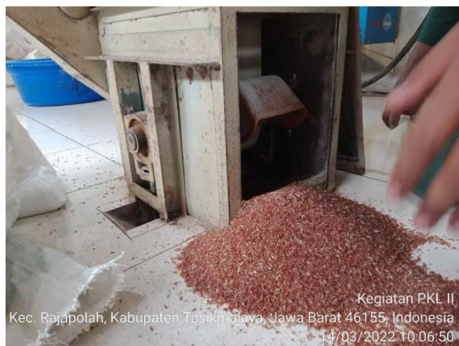
Gambar 7. Pembersihan bagian elevator
