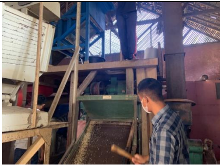
Proses sortasi beras menggunakan separator
