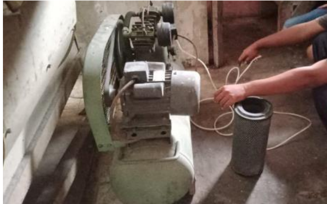
Gambar 5. Pembersihan filter udara
