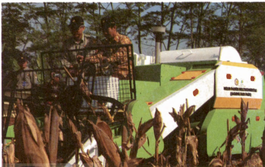
Gambar 54. Kemajuan alsintan berupa mesin panen multikomoditas (padi dan jagung).
