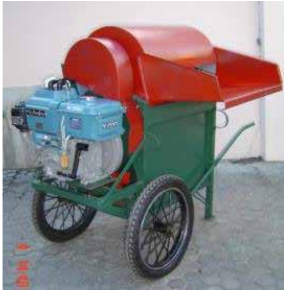
Gambar 69. Mesin perontok padi tipe throw-in dengan penggerak motor diesel.
