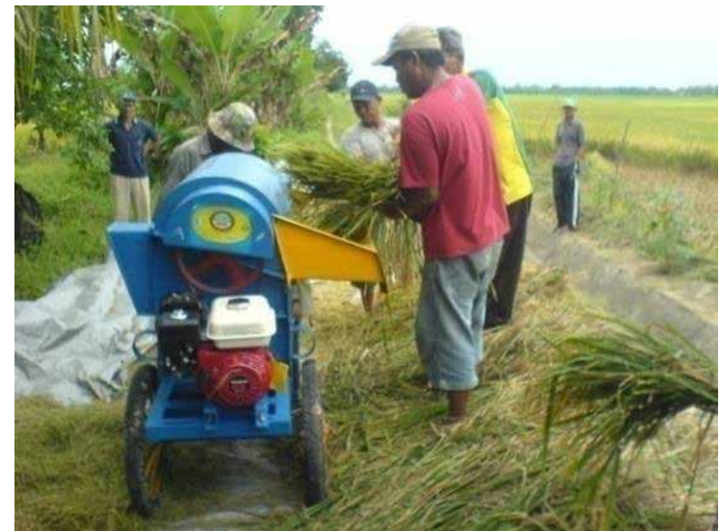
Gambar 68. Mesin perontok padi tipe throw-in dengan penggerak motor bensin.
