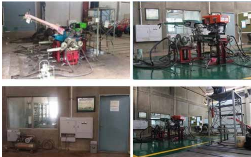
Gambar 37. Test rig untuk uji power pada poros traktor roda 2 dan uji konsumsi bahan bakar.
