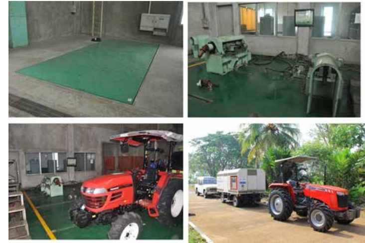
Gambar 38. Test rig untuk uji power pada poros traktor roda 4 dan uji konsumsi bahan bakar.
