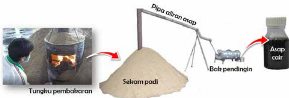
Gambar 87. Proses produksi asap cair dari sekam padi secara sederhana.
