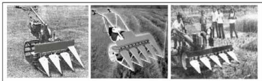
Gambar 61. Klasifikasi mesin panen padi Reaper berdasarkan lebar kerja.
