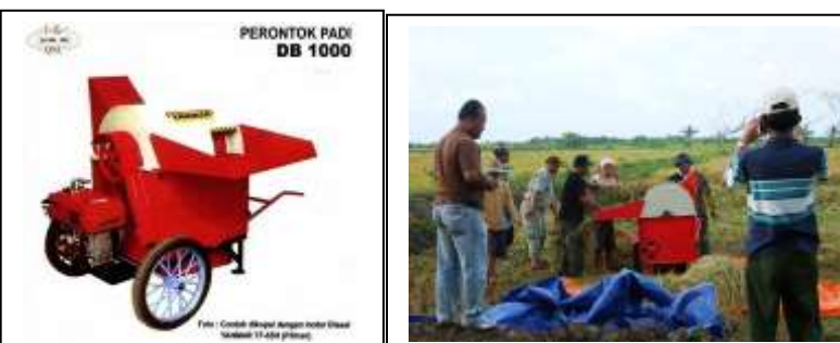
Gambar 6. Thresher : Merk : Yanmar DB 1000 Daya : disesel 5,5 HP Bobot : 130 kg Jumlah operator : 3 orang Kapasitas kerja : 600 kg/jam
