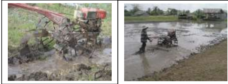
Gambar 2. Hand tractor Jenis : Traktor tangan Merk : Quick, Yanmar, Agrindo Daya rata-rata : 8,5 HP Kapasitas kerja : 0,06 ha/jam Jumlah operator : 1 orang
