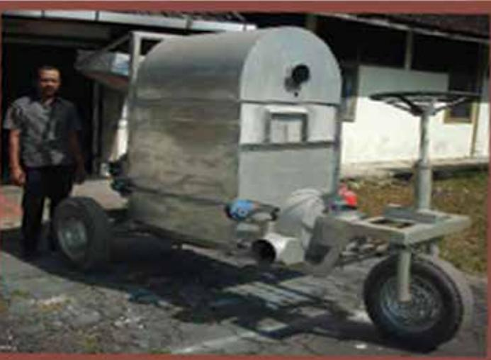
Alat ini terbuat dari dua komponen utama yaitu drum pengering yang dilengkapi sirip luar dan dalam. Alat pengering polong kacang tanah dirancang menggunakan dudukan mesin yang dilengkapi dengan roda, stir, rem, v-belt, dan injakan kaki yang dapat digunakan untuk mobilisasi.
