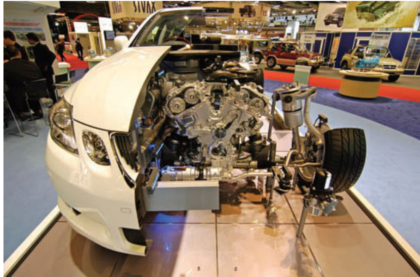
Gambar 1. Irisan Sebuah Mobil yang Memperlihatkan Ruang Bakar (Sumber: Thermodynamics, Cengel )
