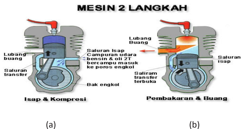
Gambar 18. Prinsip Kerja Motor Dua Langkah (a) Langkah Hisap dan Kompresi
