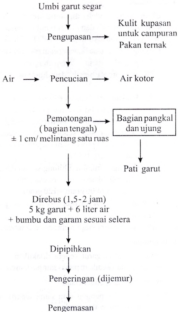
Gambar 5. Diagram proses pembuatan emping berbumbu
