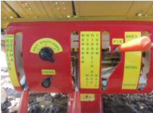
Gambar 6. Tuas Menghidupkan Mesin
