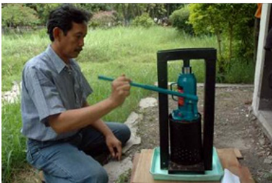
Pengepresan biji dengan hidrolik press
