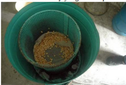
Pemisahan sisa minyak dengan centrifuge
