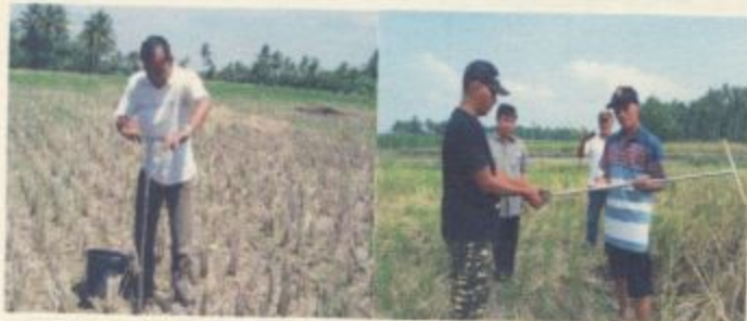
Pengambilan Contoh Tanah Menggunakan Alat Bor Tanah Mineral
