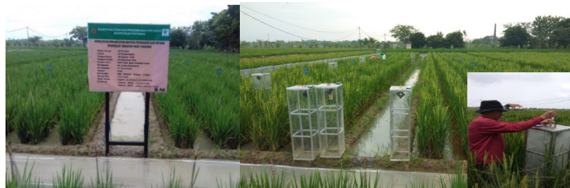
Gambar 27. Pertumbuhan tanaman padi yang diaplikasi dengan bakteri pengoksidasi metana dan pengambilan gas metana dari sungkup di KP Pusakanagara, BB Padi, Kabupaten Subang
