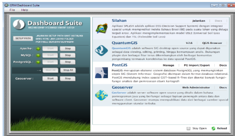
Gambar 35. Dashboard Suite yang berupa modul beberapa program open source (QuantumGIS, PostGIS, dan Geoserver). Modul inilah yang menjadi mesin analisa DSS konservasi tanah & penampil fitur-fitur dalam aplikasi SILAHAN.
