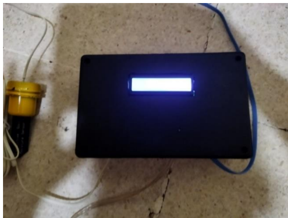
Gambar 16. Mikrokontroler pompa pendorong
