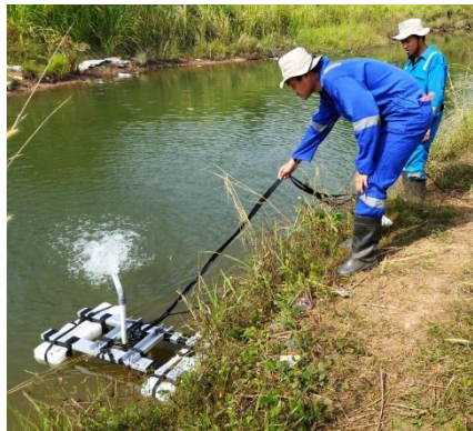
Gambar 56. Pengujian pompa air di sungai
