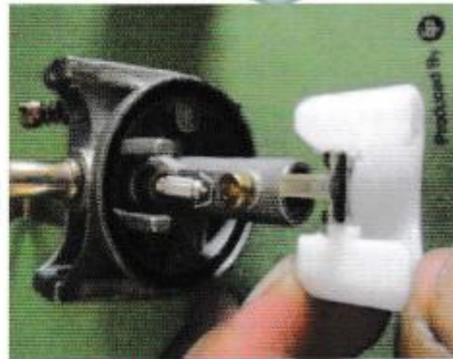
Melepas nipel spuyer dengan menambah kran gas masuk
