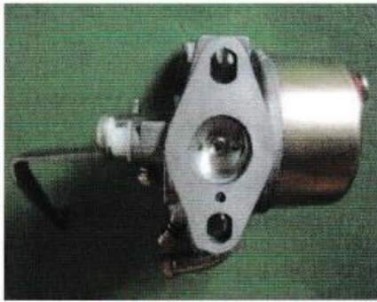
Melepas kaburator dari intake manifold
