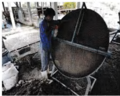
Bahan Baku dimasukkan di mesin granul
