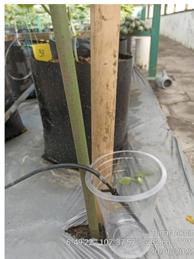
Gambar 4. 1 Pengujian Debit Penetes (Sumber : Dokumen Pribadi)
