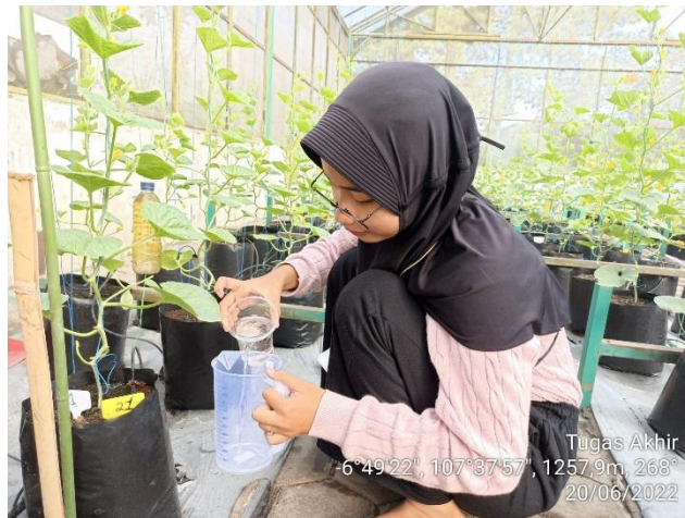
Gambar 4. 2 Pengukuran Volume Penetes (Sumber : Dokumen Pribadi)
