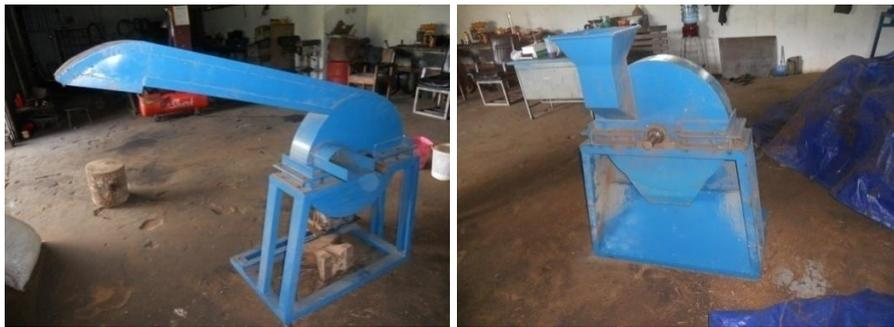
Gambar 2. Unit ayakan mekanis (kiri) dan unit pencampur bahan olah (kanan).
