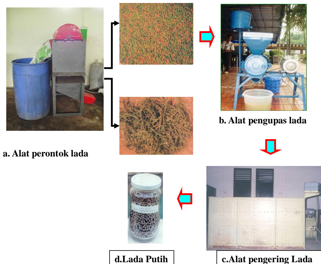
Gambar 8. Pengolahan lada putih secara masinal
