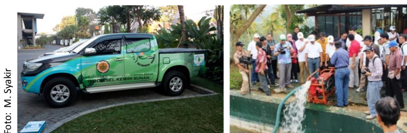
Gambar 40. Biodiesel kemiri sunan B100 yang digunakan pada mobil bermesin diesel dan pompa air
