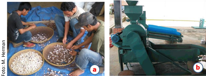
Gambar 35. Pemisahan kernel kemiri sunan dari biji secara manual (a) dan menggunakan mesin decorticator (b)
