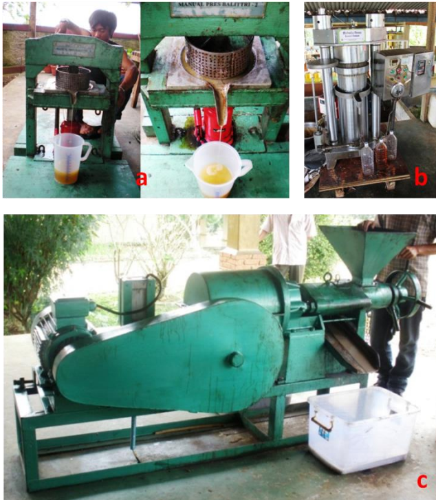
Gambar 36. Pengepresan kernel kemiri sunan menggunakan hidrolik manual (a), hidrolik elektronik (b), dan screw press (c).
