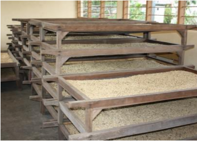
Gambar 13. Contoh rak dan penjemuran biji kopi pada pengolahan basah
