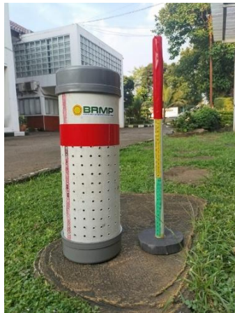
Gambar 11. Desain Pipa kontrol AWD (Sumber: BRMP Agroklimat)
