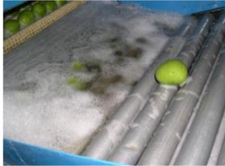
Gambar 22. pencucian buah dengan mesin
