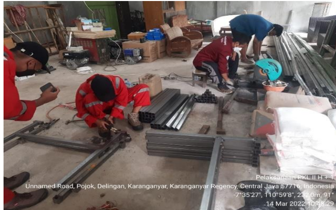
Gambar 15. Pemotongan dan Pengelasan Besi Hollow
