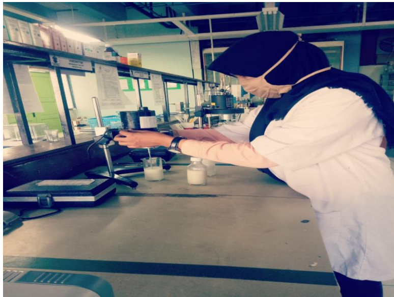
Gambar 24. Pengukuran Viskositas Susu Pasteurisasi Ekstrak Daun Matoa
