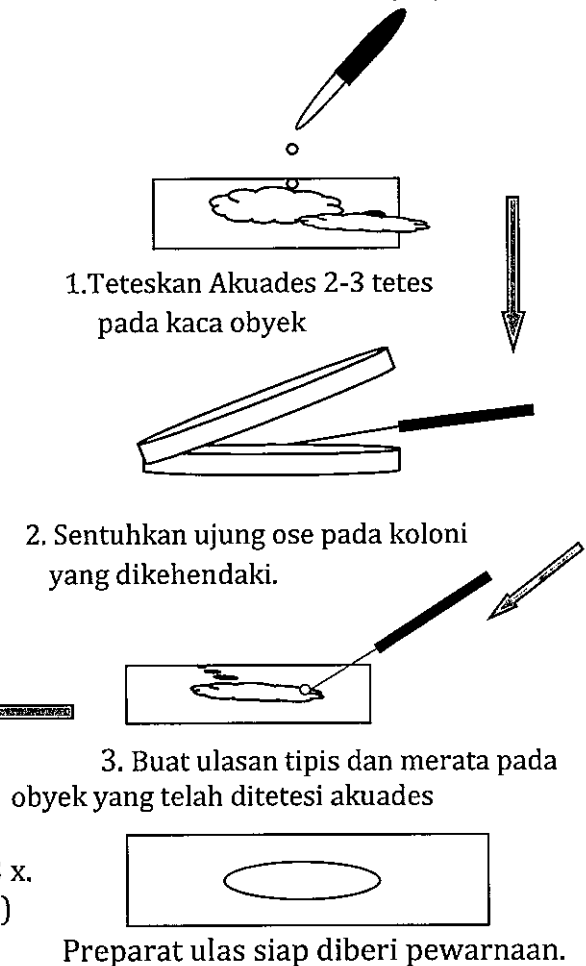
Gambar 6-3. Serangkaian Prosedur Membuat Preparat Ulas Bakteri
