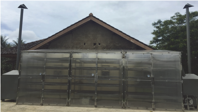
Gambar 17. Alat pengeringan hybrid yang dilengkapi dengan pengukur suhu
