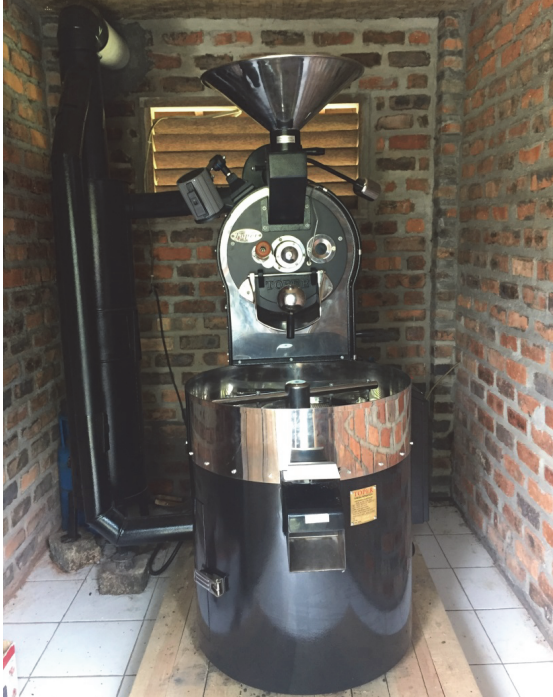
Gambar 22. Mesin penyangrai kopi
