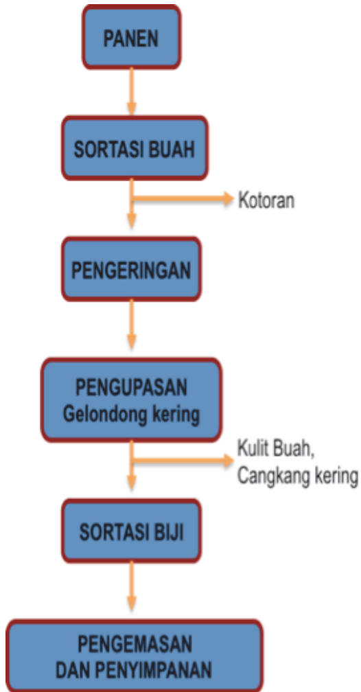
Gambar 1. Tahapan pengolahan kopi cara kering
