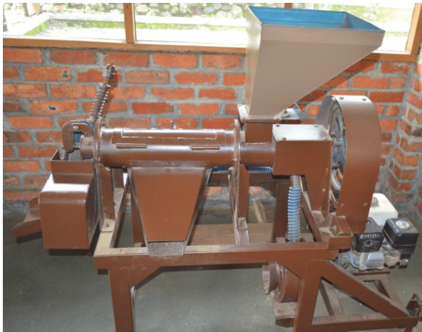
Gambar 18. Mesin pengupas kulit kopi kering ( huller ) tipe Engelberg .
