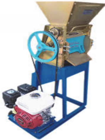
Gambar 8. Mesin pengupas kulit buah kopi basah tipe vis-pulper
