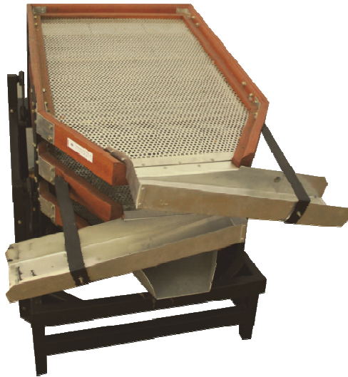
Gambar 19. Mesin ayakan mekanis sortasi biji kopi dengan kapasitas 400 kg/jam
