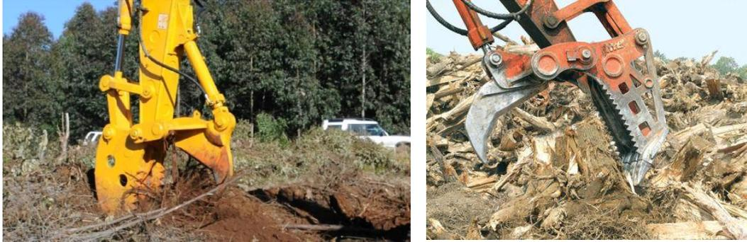
Gambar 5. Penggalian tunggul dengan alat *excavator stump harvester*
