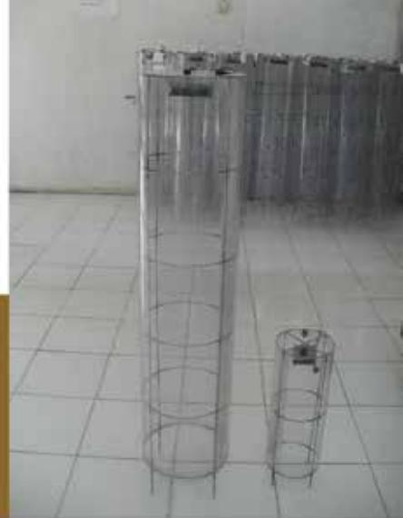
Pengukuran emisi GRK pada skala percobaan rumah kaca membutuhkan sungkup yang dapat digunakan untuk membantu pengambilan sampel gas dari tanah dan tanaman. Sungkup yang banyak beredar di pasaran berukuran besar, mahal, sulit dibawa ke lapangan, dan tidak praktis untuk percobaan rumah kaca. Modifikasi sungkup hasil invensi Balitbangtan kali ini memiliki kesamaan fungsi, namun dilengkapi dengan beberapa kelebihan. Sungkup ini terdiri dari bodi sungkup, penutup sungkup, kipas plastik, dan septum.
