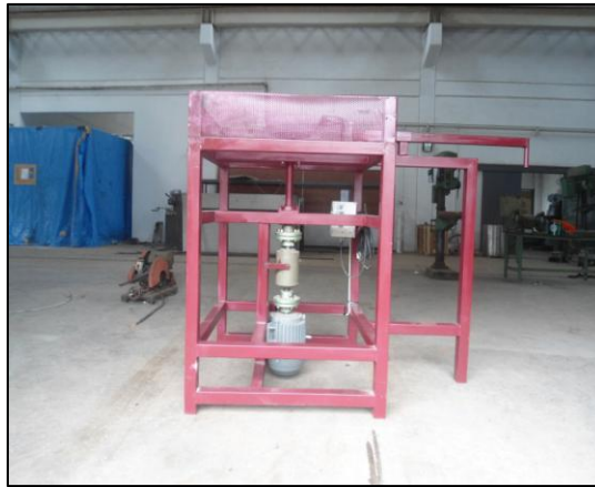
Gambar 18. Aparatus uji torsi pemotongan batang tebu
