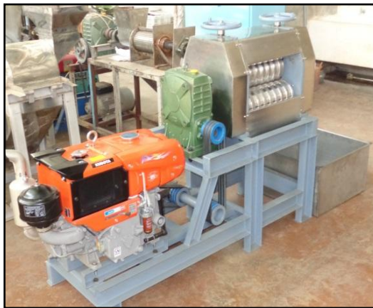
Gambar 5. Mesin Pemas Nira Tebu
