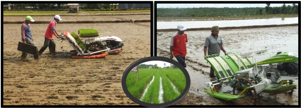
Gambar 22. Mesin Tanam Pindah Jarwo Transplanter saat uji lapang
