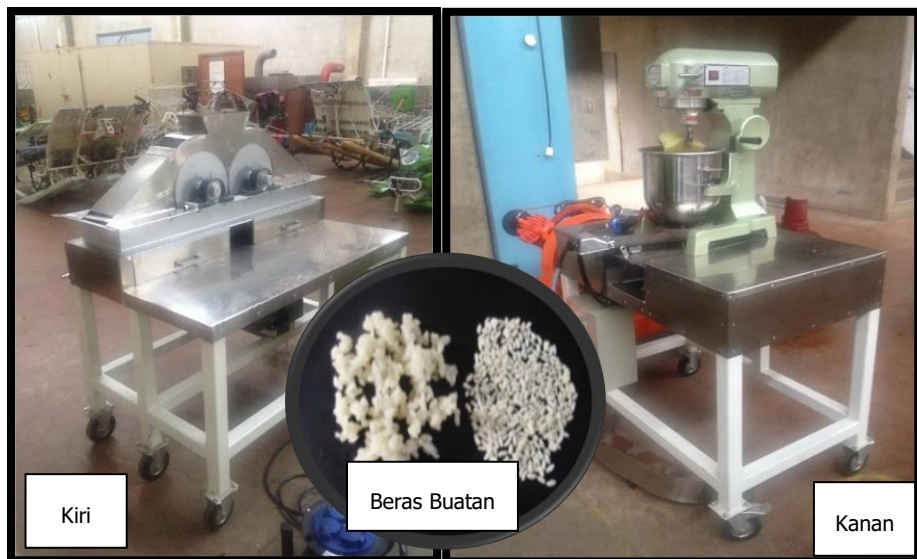
Gambar 20. Alat Pencetak Beras (kiri) dan Pengaduk Adonan (kanan)
