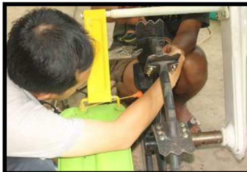
Gambar 4. Bentuk cakar dan Pemasangannya pada "lug" roda transplanter
