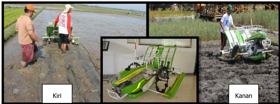
Gambar 6. Uji fungsional jari-jari roda JarwoTransplanter Prototipe II pada tanah bertekstur lempenggenangan air (kiri) di Desa Kawunganten, Kab. Cilacap dan dengan gepung pasir tanpa nangan air 2 cm (kanan) di Desa Kepanjen, Kab. Malang
