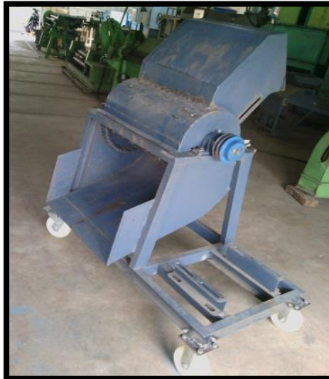
Gambar 15. Mesin pencacah tandan kosong sawit
