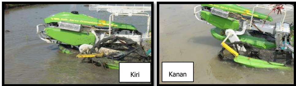
Gambar 3. Lengan hidrolik dan kotak rantai pemegang as roda dalam posisi sudut <30^{\circ} (kiri) dan posisi sudut >70 (kanan)
