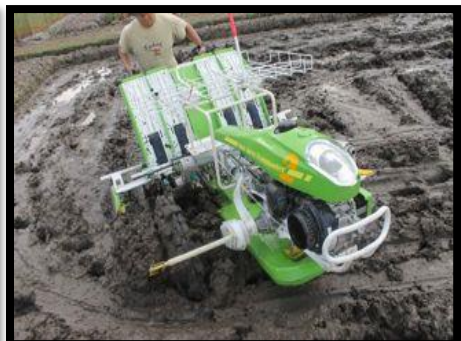
Gambar 5. Roda bercakar mesin Indo Jarwo Prototipe II
