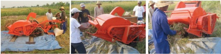
Gambar 4.28. Uji kinerja Stripper Gunung Biru Stationary
