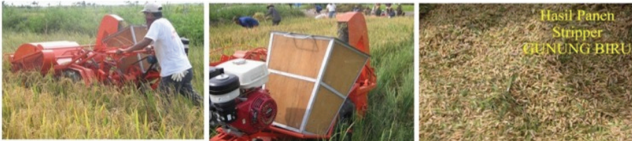
Gambar 4.27. Uji kinerja Stripper Gunung Biru dil lapang
