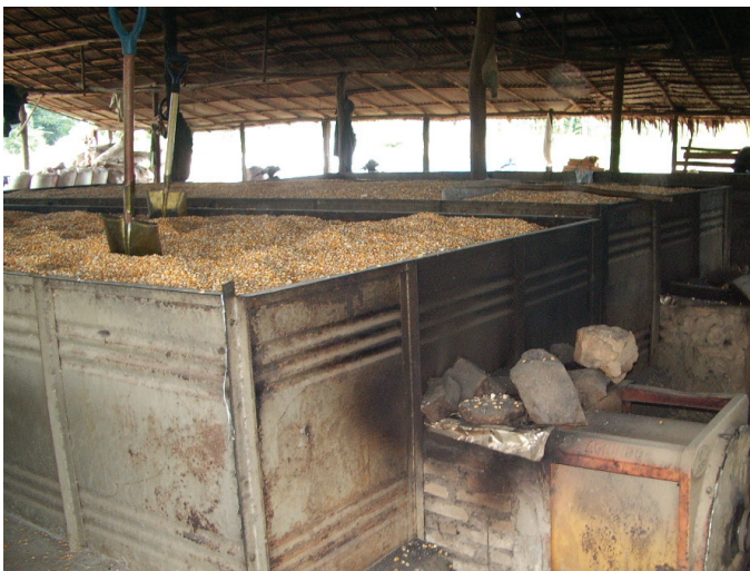
Gambar 5.12. Mesin pengering tipe bak berbahan bakar kayu
