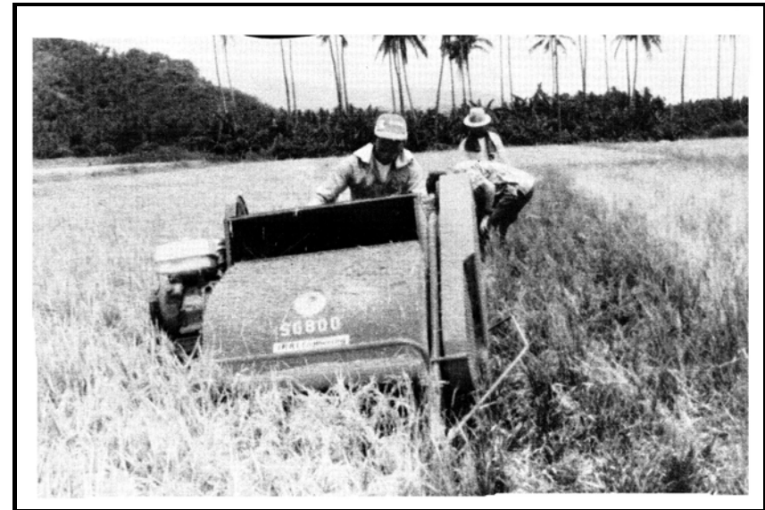
Gambar 1. Operasional Mesin penyisir padi di lapangan
