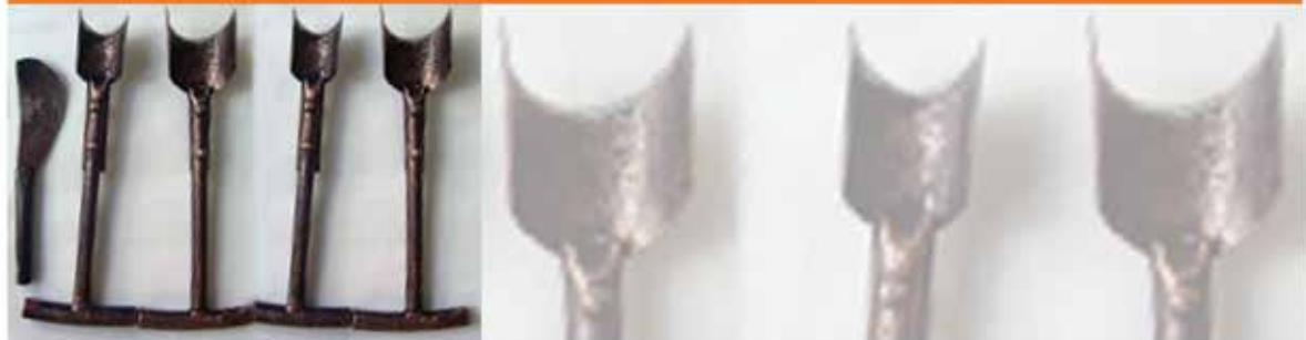
Alat penyisir pisang digunakan untuk melepaskan sisir pisang dari tandannya dan buah yang ada pada sisir tidak terluka. Penyisiran secara tradisional sulit dilakukan apabila susunan sisir buah dalam tandan agak rapat, dan menghasilkan potongan sisir yang tidak rapih.
