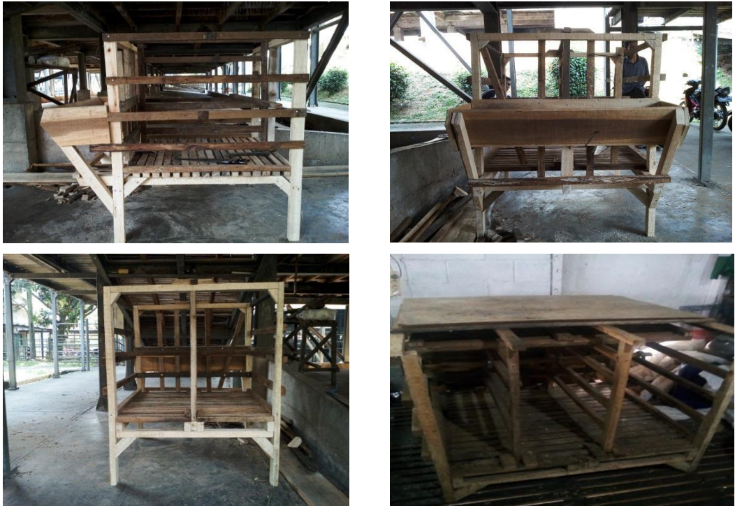
Gambar 1. Proses pembuatan kandang jepit ( restrain cage ) berbahan dasar kayu untuk ruminansia kecil.
