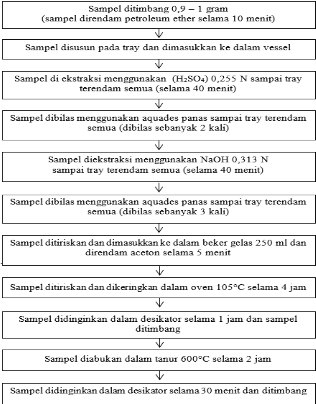
Gambar 1. Diagram alir cara kerja analisis serat kasar pakan ternak dengan fiber analyzer Ankom 200
