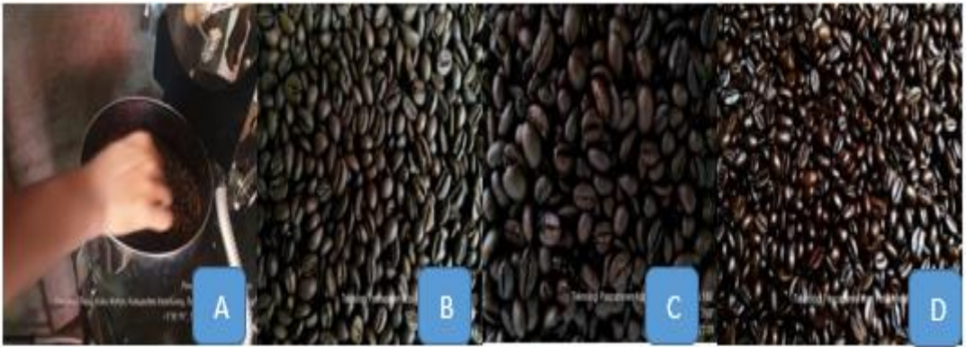
Gambar 2. A). pendinginan hasil roasting , B). roasting 150°C, C). roasting 180°C D). roasting 205°C
