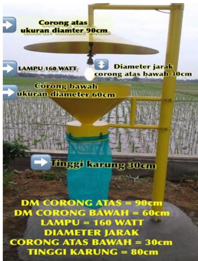
Gambar 1. Lampu perangkap BSE G-4 Desain Baehaki, 2009
