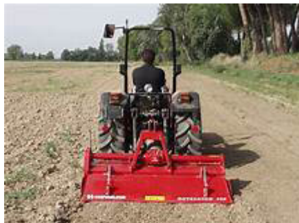
Gambar 27. Pengolahan Tanah dengan Rotary Plow
