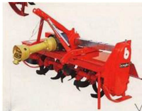
Gambar 26. Rotary Plow dengan Titik-Titik Gandengnya
