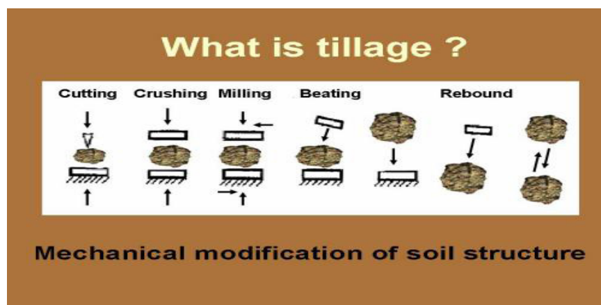
Gambar 1. Pengolahan Tanah melalui Berbagai Interaksi Tanah dan Alat Pengolahan Tanah
