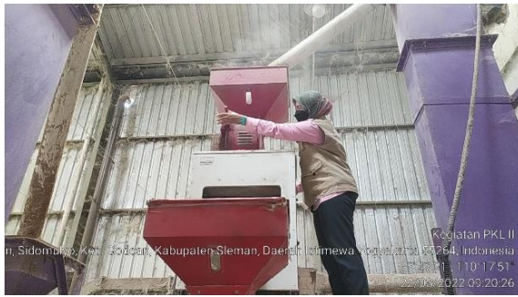
Memeriksa kerapatan rubber roll pada husker mesin RMU
