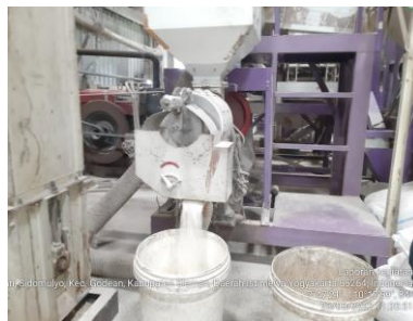
Gambar 28. Penyosohan beras dengan sistem abrasi
