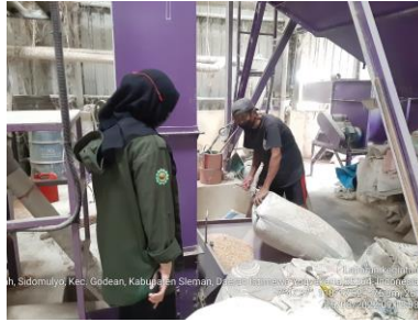
Gambar 38. Elevator 1 dan Hopper tempat pemasukan gabah
