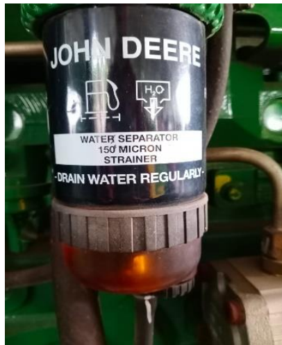
Gambar 7. Bagian Water separator
