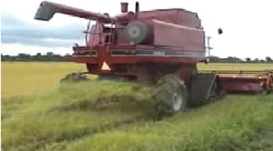
Gambar 4.9. Setelah memungut dan memisahkan bulir-bulir padi, tanaman padi atau jerami langsung dihancurkan saat itu juga, dipotong-potong halus dan ditumpahkan kembali ke lahan.
