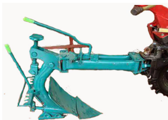
Gambar 8. Sistem Penggandengan Satu Titik
