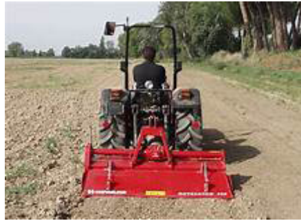
Gambar 27. Pengolahan Tanah dengan Rotary Plow
