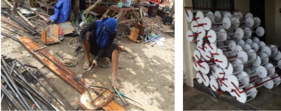
Gambar 5. Pengerjaan pengelasan tangkai caplak dan hasil produksi caplak
