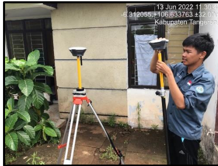
Gambar 5. Menyiapkan Alat GPS RTK (Sumber : Dokumentasi Pribadi)
