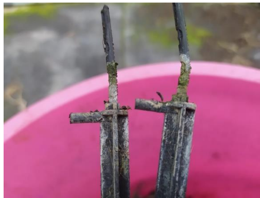
Gambar 4.1 Sisa kerak nutrisi dan lumut yang menempel pada dripstick
