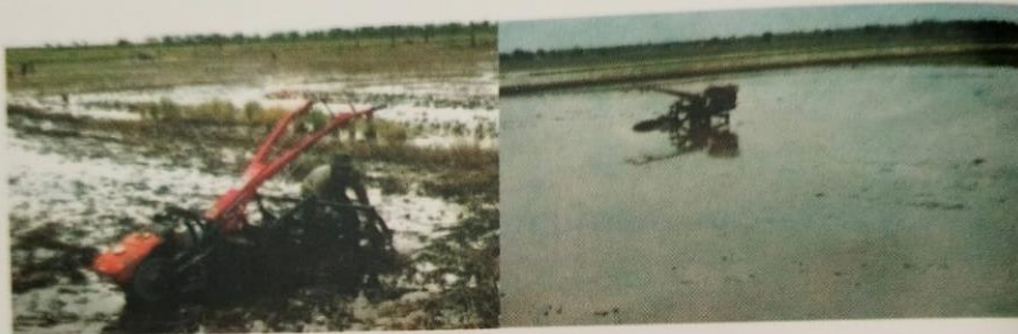
Gambar 1. Sistem penyiapan lahan dengan cara menggunakan hand tractor
