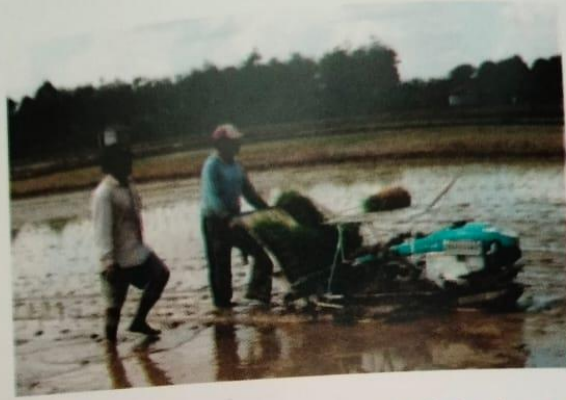
Gambar 11. Penerapan alat tanam padi ( rice transplanter ) sistem tegel Sungai Sugih
