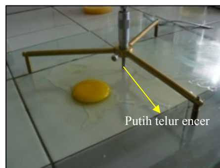
Gambar 11. Pengukuran tinggi putih telur encer menggunakan Depth Mikrometer .
