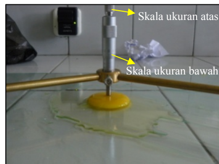
Gambar 7. Pengukuran tinggi kuning telur menggunakan Depth Mikrometer .
