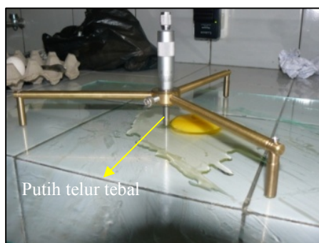
Gambar 10. Pengukuran tinggi putih telur tebal menggunakan Depth Mikrometer .
