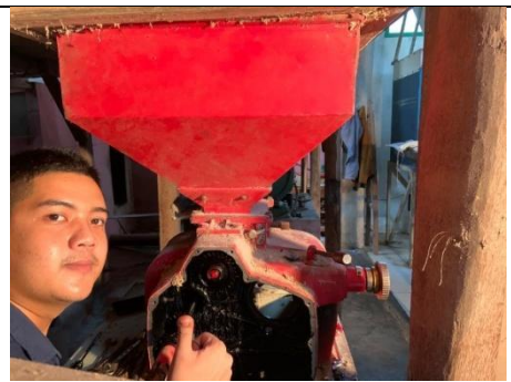
Pembongkaran mesin RMU
