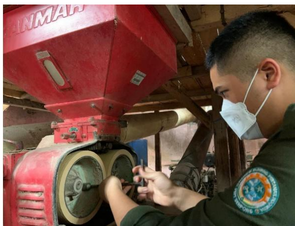
Gambar 10. Pemeliharaan harian mesin husker
