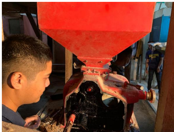
Gambar 14. Perbaikan mesin husker
