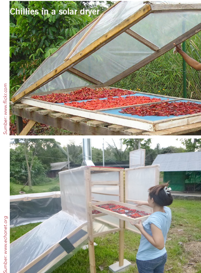
Alat pengering cabai konvensional berbentuk tudung dan lemari dengan dinding dari plastik dan rangka dari kayu
