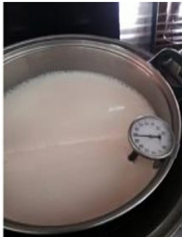
Gambar 8. Proses pasteurisasi susu kambing
